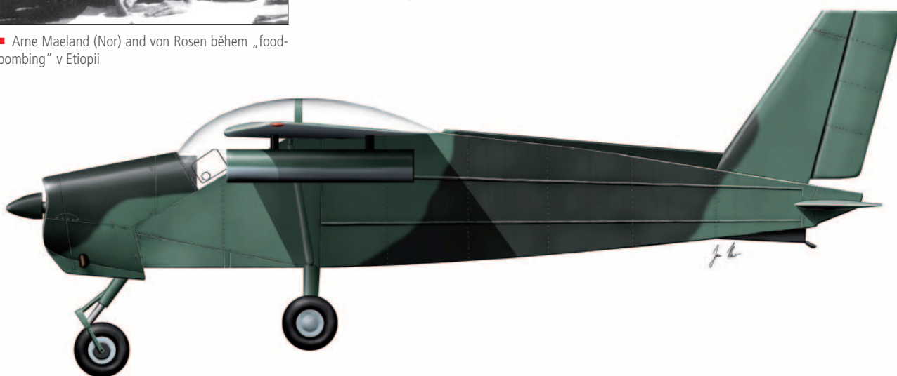
■ Původně sportovní letoun Malmö MFI-9 Trainer v barvách tzv. MFI Squadron, již se přezdívalo Děti Biafry. Letouny MFI-9B nesly kamufláž tvořenou barvami zelených odstínů původně určených pro automobily Volkswagen, což byly jediné dostupné barvy. Kamufláž byla natřena obyčejnými štětkami, neboť stříkáčkové pistole nebyly k dispozici
